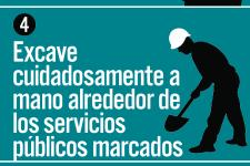
Si daña una línea de gas natural y hay gas soplado, salga de la zona, llame al 911 y luego a Cascade. Reporte TODAS las líneas de gas natural dañadas, incluido el daño al cable de recubierto paralelo a la línea de gas, a Cascade, incluso si no hay gas de soplado. Los pequeños cortes y daños en la envoltura de la línea de gas, o daños en el cable, pueden ser peligrosos si no se reparan.
